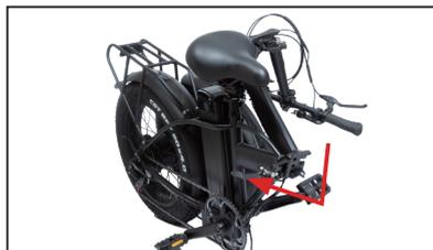
1. フレーム部の折りたたみから解消します。前輪と後輪を遠ざける形で、フレームを展開します。
