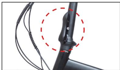
1. ボールホルダーを引き、ロックを外します。ボールホルダーはボタンを押して操作します。
