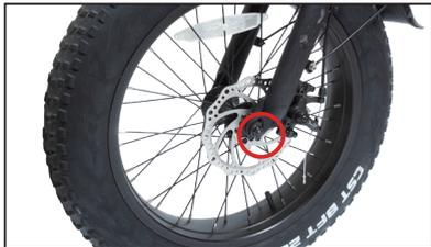
前車輪を留めているネジに緩みが無いことを確認する。緩みがある場合は十分に締める。
