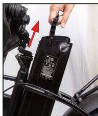
3. バッテリーロックを外し、バッテリーを取り外します。
