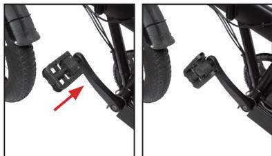
5. ペダルを外側から押し込み、折り曲げて収納することができます。折り曲げを戻すことで、展開となります。
