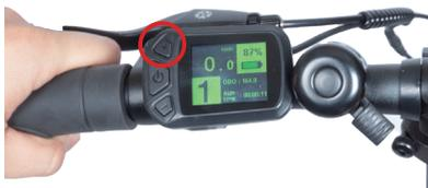
2. フロントライトが点灯することを確認します。消灯する場合、液晶モニターの+ボタンを2～3秒長押しします。
