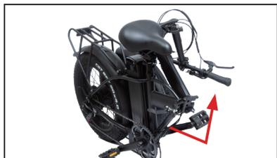
4. フレーム部を折り曲げて前輪と後輪を近づけるイメージで折りたたみます。
