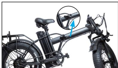
3. フレームホルダーを引き、ロックを外します。フレームホルダーは機構は二重ロックとなっているためご注意ください。
